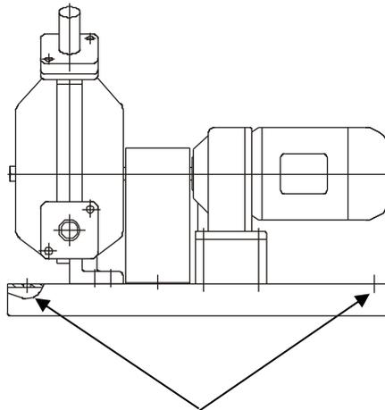
**Bohrungen zum Heben der Pumpe
