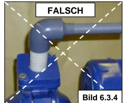
Bei der Installation sollten zur Vermeidung von Druckspitzen, die die Pumpenschläuche schädigen können, keine 90° Winkel oder Bögen direkt hinter der Pumpe montiert werden (siehe Bild 6.3.2 und 6.3.3). Es sollten ebenfalls keine Reduzierungen des Leitungsquerschnittes vorgenommen werden (siehe Bild 6.3.4).
